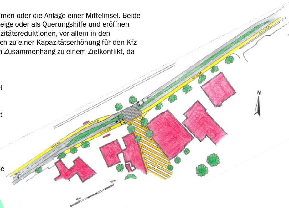
Seestraße L190 zwischen Montfortstraße und HTL-Kreisel – Fahrstreifenreduktion und Busspur
